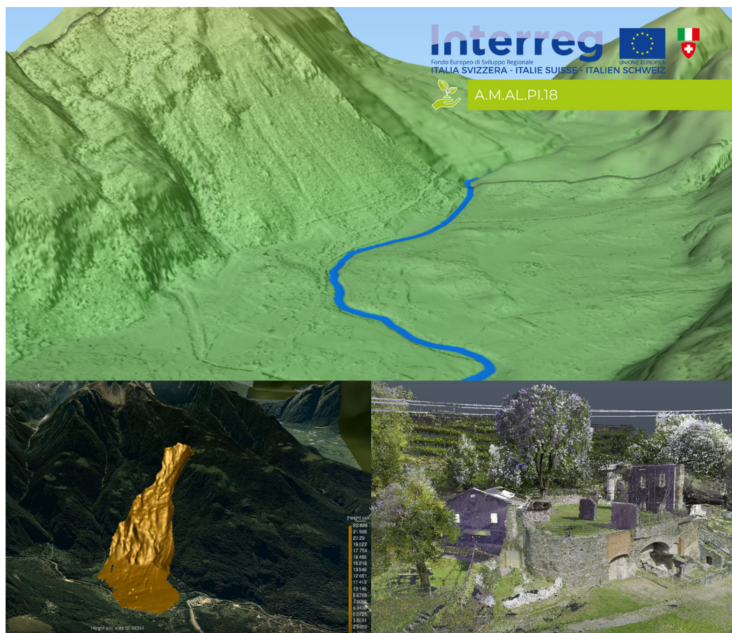
Figura 3: [Da sopra] Modello digitale del terreno, località Piuro (Chiavenna). [Sotto, sinistra] Simulazione della frana di Piuro, avvenuta nel 1618. [sotto, destra] Elaborazione 3D in formato nuvola di punti dell'Area degli scavi di Belfort.
