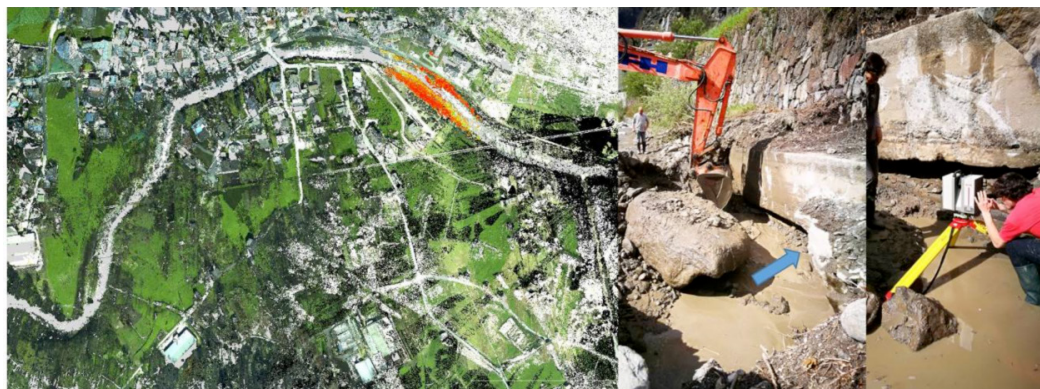
Figura 6: Piuro – Localizzazione (rosso) del rilievo laser scanner, alcune fasi dei rilievi.
